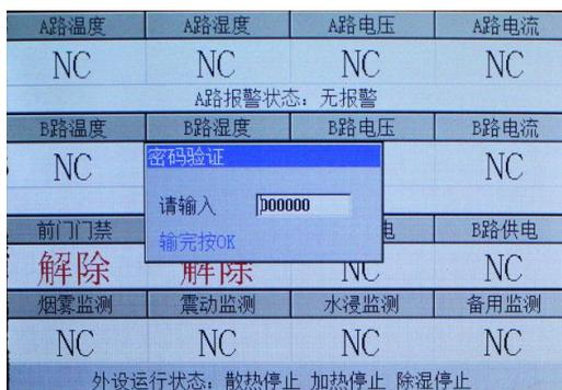
初始管理密码为空值，首次进入系统配置界面时无需输入密码，直接按确认键即可。进入系统配置后按左、右方向键可以选择不同的设置，系统菜单共包含七个菜单，如下图所示。
