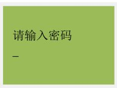
此时用户可以按数字键输入密码，密码长度为 1-6 位。密码输入完毕后按“确认”键，系统将检验您输入的密码是否正确。如果输入的密码不正确，系统会提示密码错误，并要求用户重新输入，此时用户可以重新输入密码或按 ESC 键取消设置，返回系统主窗口。
