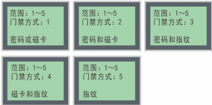
输入相应数字后按确认键，系统会提示保存设置。此时可以按确认键保存设置，或按 ESC 键取消设置，返回门禁管理界面。
