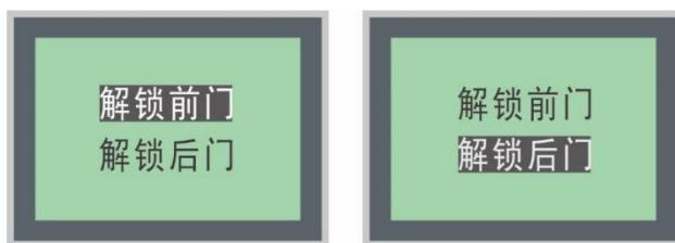
然后按“确定”键解除门禁，此时屏幕显示柜门已经打开的提示，如下图所示：
