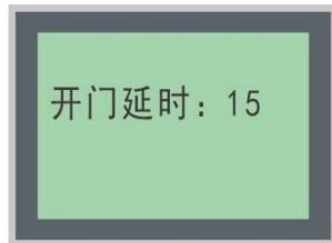
开门延时用于解除门禁后，长时间没有打开柜门时自动重新启动门禁。在开门延时设置界面内按数字键输入延时时长，然后按确认键保存即可。
