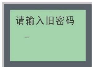
输入完毕按确认键，如果所输入的旧密码正确，系统会提示输入新密码，输入新密码后按确认键，然后再次输入进行确认，如下图所示：
