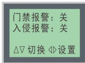
在开门报警设置界面内按上、下方向键可以选择门禁报警或入侵报警。选择门禁报警时，只要系统监测到机柜有开锁动作即会发送报警信息。如果选择入侵报警，则系统会在监测到机柜没有解除门禁的情况下发生开锁动作时，发送报警信息。
